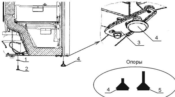
5.6. Отрегулируйте положение регулировочных опор 4 и 5, чтобы холодильник устойчиво стоял на полу с небольшим наклоном назад. Отрегулировав наклон правильно, вы обеспечите облегченное и самопроизвольное закрывание дверей.
